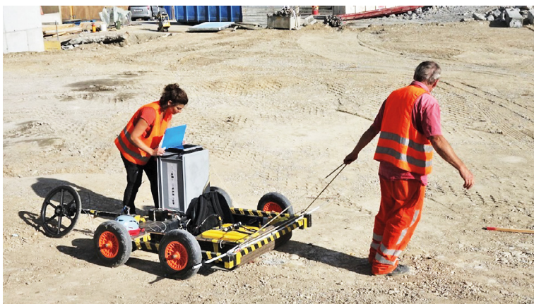
Fig. 8: Das Georadar-Equipment in Aktion [Bild Th. Rügegg, 15.08.2017].
